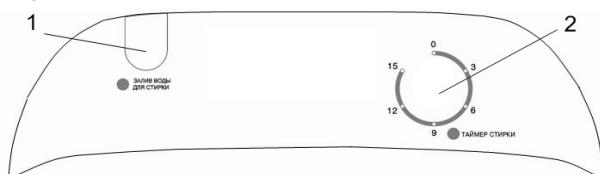
1 - отверстие для залива воды; 2 - таймер стирки.
